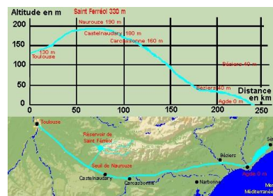
L'alimentation en eau du canal du midi
